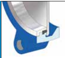
Abdichtung Typ B (verstärkte Ausführung)
